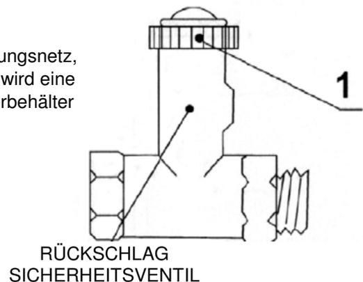
1. Der Drehgriff dient zum Öffnen und Schließen des Sicherheitsventils. Überprüft wird er so, indem der Drehgriff so weit nach links geöffnet wird bis ein Überspringen des Gewindes zu vernehmen ist. Dabei fängt das Wasser durch den Düsenabfluss zu rinnen an, das zeigt, dass das Ventil richtig funktioniert. Nachdem Sie das überprüft haben, drehen Sie den Drehgriff bzw. die Mutter nach rechts bis zur Ausgangsposition zu.
